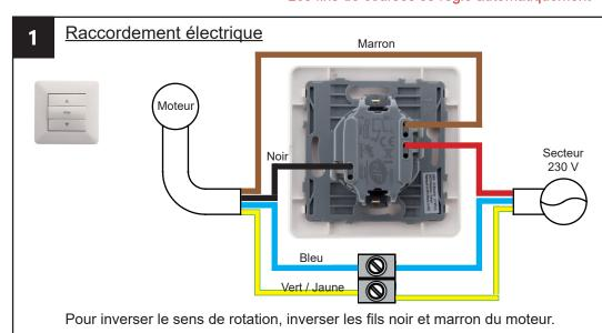
L'installation doit être conforme à la norme NFC-15100
